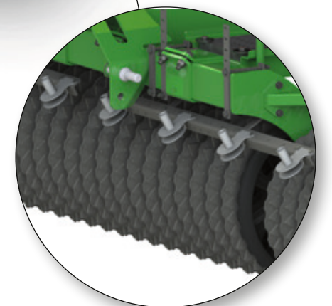
Prallteller für eine gleichmäßige Verteilung
