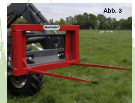
Adapter für Weidemann-Hoftracs Die Kupplungsmöglichkeit für alle Geräte mit Euro-Aufnahme. Mit hydraulischer Verriegelung. Gewicht: 76 kg
