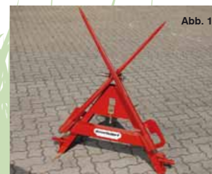
3-Punktadapter Kat. 2 Alle Frontgeräte mit Schnellwechsellaufnahme (Euronorm) können mit Hilfe des 3-Punktadapters an die Schlepper Heck- bzw. Fronthydraulik angebaut werden. Gewicht: 65 kg
