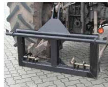
3-Punktadapter Kat. 2 Alle Frontgeräte mit Schnellwechsellaufnahme (Euronorm) können mit Hilfe des 3-Punktadapters an die Schlepper Heck- bzw. Fronthydraulik angebaut werden. Gewicht: 65 kg
