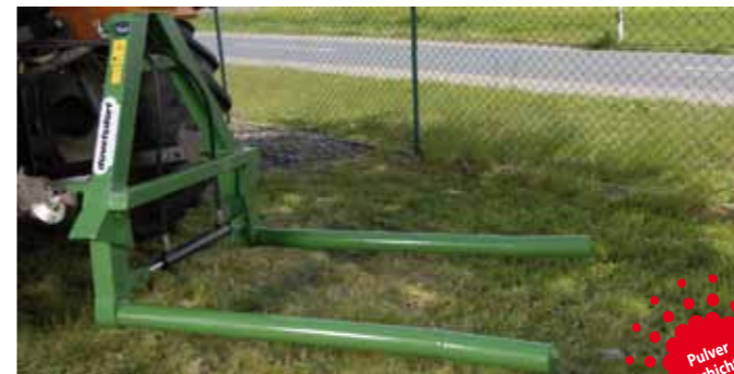
Rundballengabel, 3-Punkt, hydraulisch Gewicht: 100 kg
