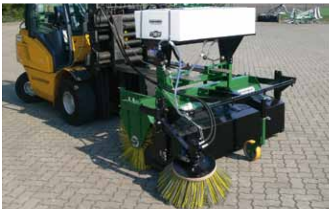
Kehmaschine DKBW-S 1,7 mit Sprüheinrichtung und Seitenkehrbesen
