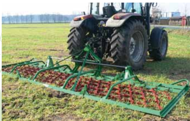
6 m Egge, 4-reihig, hydraulisch klappbar
