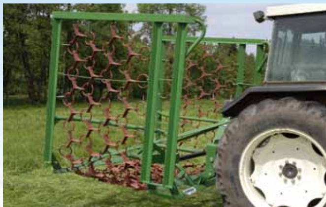
6 m Egge, 4-reihig, hydraulisch klappbar
