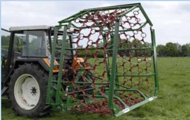
8 m Egge, 4-reihig, hydraulisch klappbar
