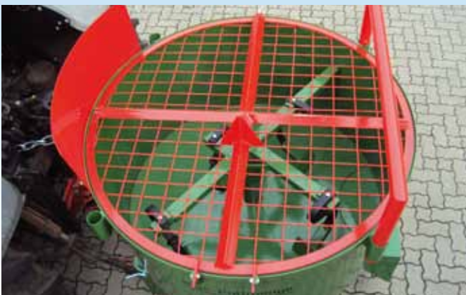
Spritzblech, Abkippbügel, Sacköffner - DBM 750
